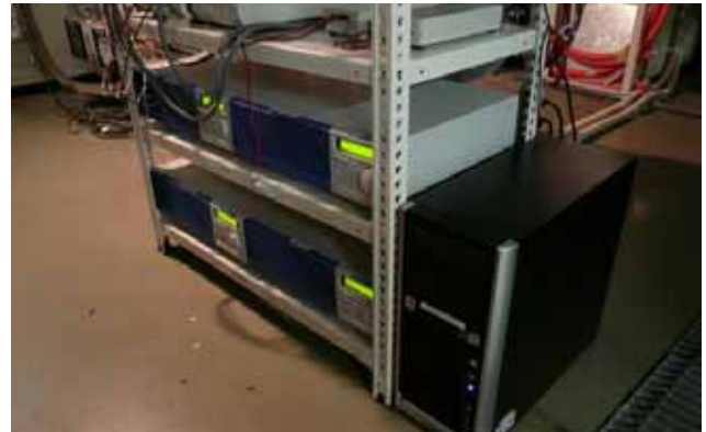
図 8.2.18 電力模擬負荷 (1kW 4台)
