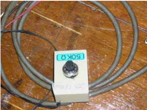
(c)電圧調整装置
